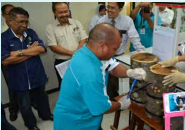
Pembantu penyelidik FRIM sedang menunjukkan demo kaedah persampelan menggunakan pengorek kenaikan ( increment borer ) untuk mendapatkan sampel teras pokok ( wood core ) dari kayu balak.
